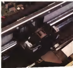
La testa di stampa della 406 capace di 400 cps, con il copercchio retrattile a rimando
